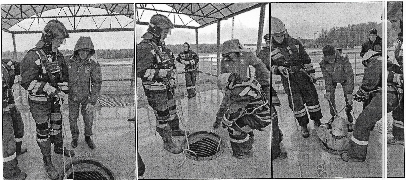
Рис.6 Основные этапы отработки эксперимента по спасению человека из колодца путем его подъема с использованием экзоскелета «Черепаша»
